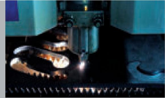
Laserschneidanlagen 4 KW und 5 KW mit Palettenwechsler und umweltfreundlicher Absauganlage.
